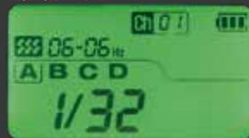
カメラのシャッタースピードをスローシャッターに設定しマルチ発光モードを組み合わせて動きのある被写体を一つの画像に多重撮影することができます。
