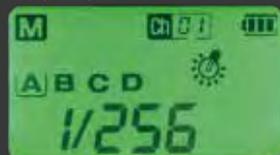
B 240/120ストロボ出力をFULL ~1/256, 1/3EVステップで調光できます。最大4灯まで各灯に調光及び各灯のON/OFFが可能になります。
