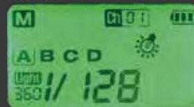
B360用モードにすることでB360の仕様にあわせた調光範囲FULL ~1/128に設定することができます。\*B240/120と混在させて使用する場合 B-240/120の最低出力は1/128となります。
